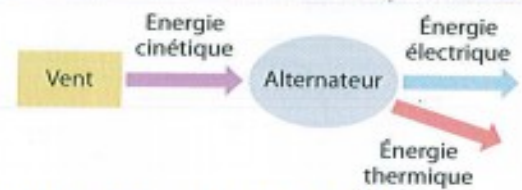
figure 2 : diagramme énergétique d'une éolienne
